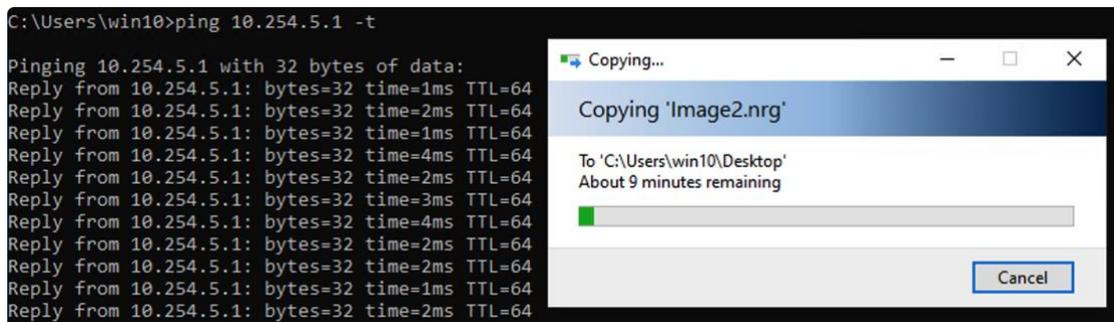
2) 拔掉 eth0 口网线，观察 AP 状态及 FTP 下载状态及 ping 状态，
