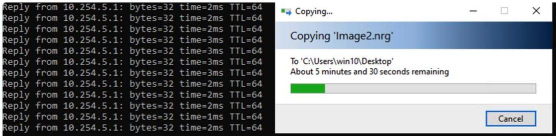
3) 开启 13 口的 power-over-ethernet 功能，观察 AP 状态和 FTP 下载状态，FTP 中断，AP 从 r->rl->D->no flag
