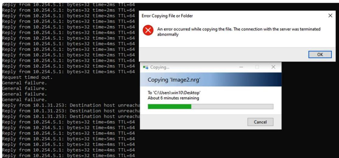
4) 拔掉 eth1 口网线, 观察 AP 状态及 FTP 下载状态, FTP 下载中断,
